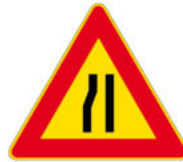
1/385 Strettoia asimmetrica a sinistra
