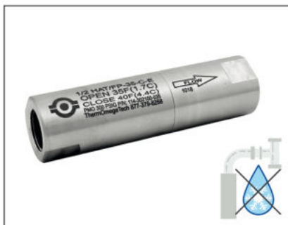
ISC9091 Kit anti-freeze per lavaocchi. Previene il congelamento dell'acqua. Una valvola termostatica apre il circuito a 1,7°C e lo chiude quando l'acqua torna sopra i 4,4°C. Misura 1/2".
