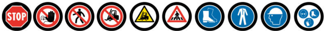
Esempi di pittogrammi di proiezione per rendere immediato il messaggio di divieto/pericolo/obbligo
